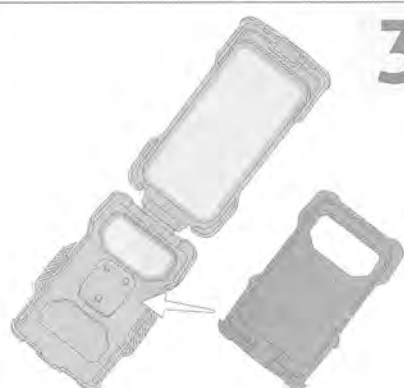
Silikon-Unterlage in die Schale einsetzen
