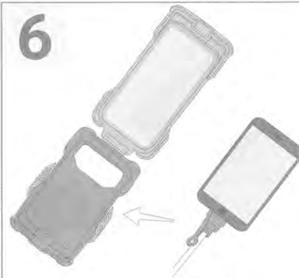
Smartphone mit Kabel in die Schale einsetzen
